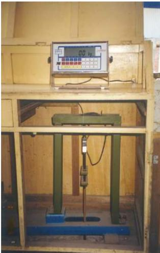
Las balanzas electromecánicas son similares a las mecánicas mencionadas anteriormente pero con una importante adición: una celda de carga análoga tipo “S” para aplicaciones en tensión, instalada en el último brazo de fuerza que conecta el sistema de palancas de la plataforma con la barra indicadora de peso, proporcionando una señal eléctrica directamente proporcional al peso aplicado a la plataforma.
