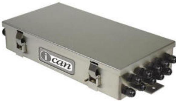
El sistema basado en la Caja de Uniones iCAN es relativamente nuevo y incorpora a un sistema análogo convencional muchas de las ventajas de los sistemas basados en celdas digitales. Esta caja de uniones especial, llamada de diferentes formas por los diversos fabricantes, convierte la señal análoga en digital, antes de llegar al indicador.
