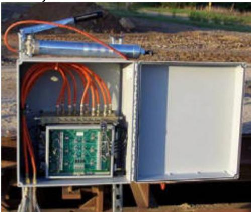
la corrosión, de preferencia acero inoxidable. La presión individual de cada celda debe ser combinada en una única salida para poder ser mostrada en un indicador de peso.
